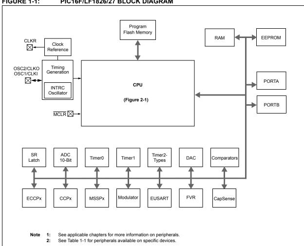
FIGURE 1-1: PIC16F/LF1826/27 BLOCK DIAGRAM
